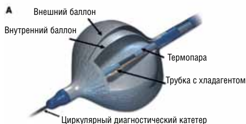
Рисунок 1. А) Компоненты криобаллона. Криобаллон первого В) и второго С) поколений. Криохладагент (N2O) поступает по трубке во внутренний баллон и отсасывается вакуумным устройством обратно во время процессов заморозки и размораживания. Терморпара контролирует температуру испаряющегося криохладагента. Внешний баллон поддерживает внутренний и является дополнительной защитой на случай его повреждения. Циркулярный диагностический катетер проводится через криобаллон и может помочь в его позиционировании в устье легочной вены, а также позволяет регистрировать потенциалы легочных вен до, во время и после абляции.
